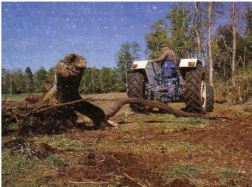
Fig. 2.- La combinación de potencia y doble tracción del tractor le permite tirar troncos. Fuente: Agricultura de las Américas.
