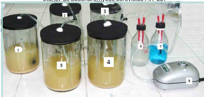
1; 2; 3; 4 y 5: Biorreactores cilíndricos aireados de 500 mL de capacidad.
